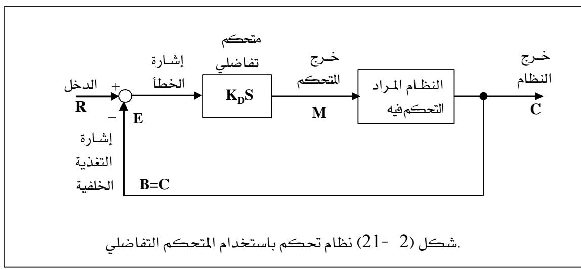
ويلاحظ أن في حالة ثبات قيمة دخل المتحكم التفاضلي (ثابت إشارة الخطأ) فإن خرج المتحكم التفاضلي يساوي صفرًا وذلك لأن تفاضل المقدار الثابت يساوي صفرًا. ولذا فإن المتحكم التفاضلي لا يستخدم بمفرده في الحياة العملية لأنه يعمل فقط في الحالات العابرة أي أثناء تغير إشارة الخطأ. ويبين شكل (2-22) العلاقة بين دخل وخرج المتحكم في حالة ما تكون إشارة دخل المتحكم عبارة عن حالة قفزة قدرها الوحدة unit step function.
